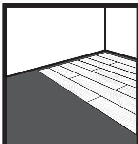
Lamelparket og laminatgulve kan lægges direkte ovenpå underlaget (gælder både 4 og 7 mm). Drejer det sig om gulvtæppe, PVC, linoleum eller andre former for gulv, er det endvidere nødvendigt med et lastfordelende underlag. 7 mm "Tæppe-kvalitet" er specielt udviklet til gulvtæpper
